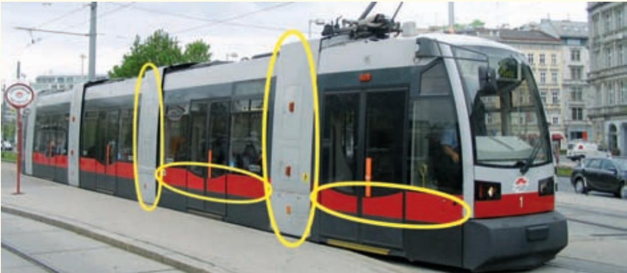
*Der konstruktionsbedingt hervorstechende Kasten für das Portalfahrwerk wurde vollständig einfarbig (hellgrau) gehalten und erzeugt dadurch eine optische Segmentierung des Fahrzeugs. Innerhalb jedes Segments verjüngen sich die roten Linienelemente zur Mitte hin, um zusätzlich auf den Einstieg aufmerksam zu machen, die Form der Glaselemente passt sich dementsprechend an.*
