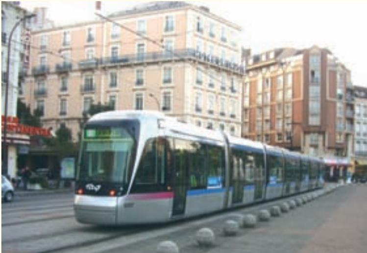
*Eine deutliche Hervorhebung kann auch dadurch erreicht werden, dass die Türen bis hinunter zur Einstiegskante als Glaselement ausgeführt werden, die Fenster hingegen nur bis maximal etwa 60 - 70 cm über die Einstiegskante hinunterreichen.*
